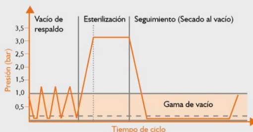
Fig. 2: Visión general del ciclo de esterilización
